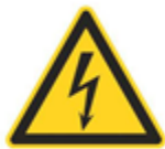
Nebezpečenstvo úrazu elektrickým prúdom
